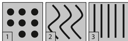
Для достижения надежного склеивания нужно обеспечить плотное прилегание поверхностей. Склениваемые поверхности необходимо прижать друг к другу, затем приложение давления не требуется. Положение изделия можно корректировать в течение 5–10 минут после приклеивания. Тяжелые изделия и не плотно прилегающие материалы рекомендуется дополнительно зафиксировать или пригрузить на период не менее 24 часов.
