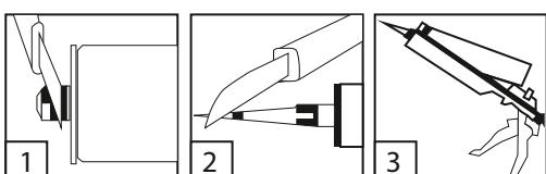
Клей наносят на одну из поверхностей: пятнами или точками (1) — на неровных основаниях, волнистыми поло-
